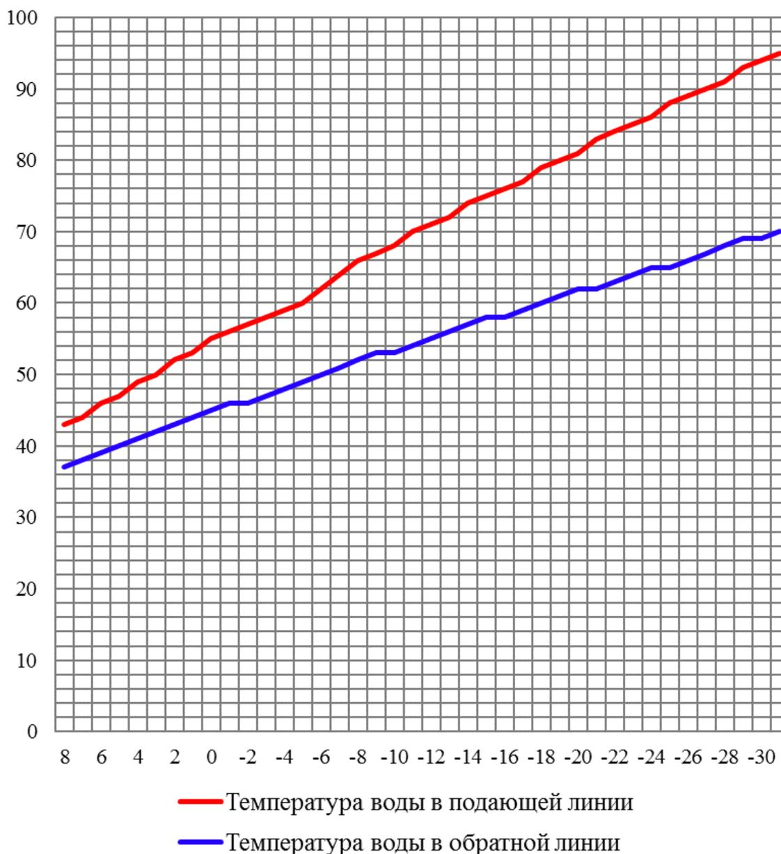
**Рисунок 4 – Графическое представление температурного графика**
